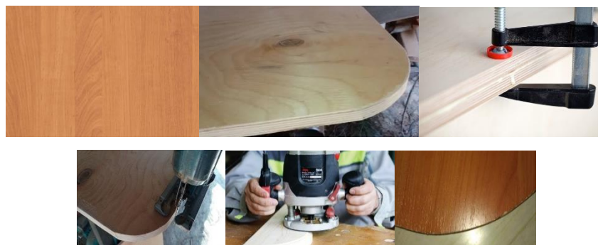
Рисунок 1 - Изготовление радиусной детали с помощью жесткого шаблона, лобзика и ручного фрезера
